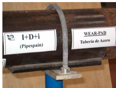
Montaje PWP sobre tubo acero
